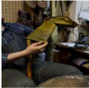
Resim 35: Meşe, gürgen yada ceviz dalından yapılmış 'dönder ağacı' ile içi dışa çevirme işlemi.
