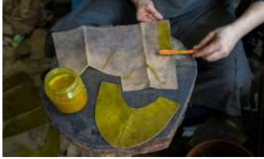
Resim 15: Yüz ve Konç'un boyanma aşaması
