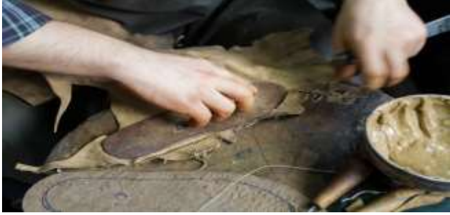
Resim 29: Taban ile yüz arasında gelen astarın kesim işlemi.
