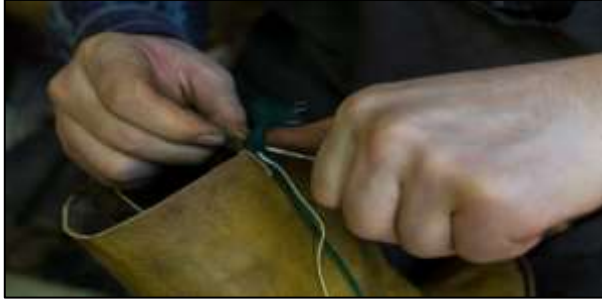
Resim 45: Edik'in boğazına süs kıyılığının dikimi işlemi.
