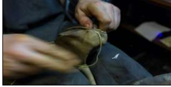
Resim 33: Burun ve arka dönemeçlerde yüzün buruşturularak kampre (bombe) verilmesi işlemi.
