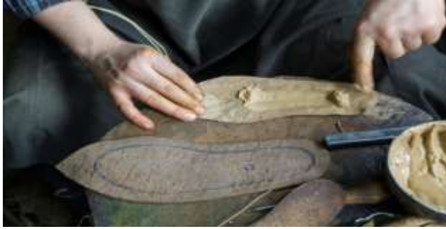
Resim 30: Taban ile astar arasında yapıştırıcı olarak çiriş malzemesinin sürülmesi.
