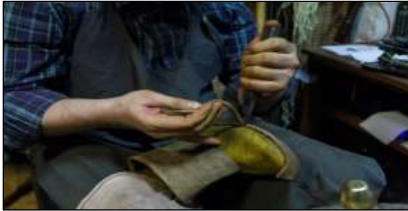
Resim 39: Şekillendirilen tabanın kıyı tıraşının yapımı.
