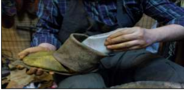
Resim 36: Düz tarafı çevrilen ediğin içine kalıbın oturtulması.
