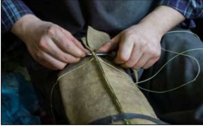
Resim 22: Dikiş işlemi yukarıdan aşağıya doğru düz bir sıra halinde bitirilir.
