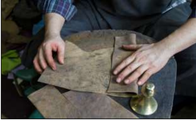
Resim 12: Ediğin konç kısmı dikiş işlemine geçmeden önce ön ve arka ortaları katlanarak bulunur.
