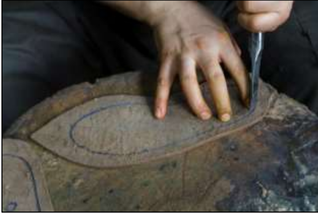
Resim 27: Taban derisinin keski ile yarılarak dikiş kanalının açılması işlemi
