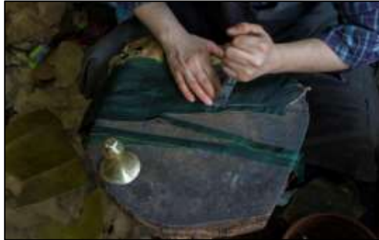
Resim 17: Süs için boyanan derinin şeritler halinde kesim işlemi.
