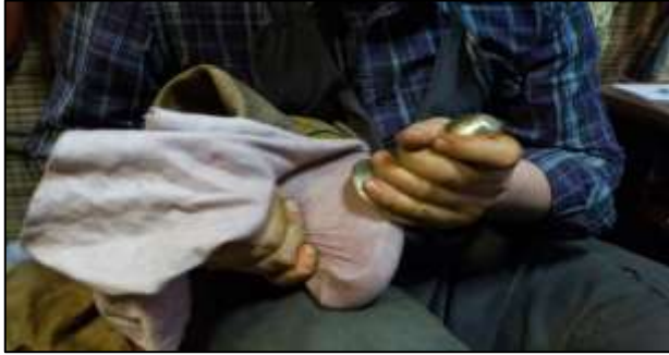
Resim 38: İç kalıbı oturtulan ediğin tabanına şekil verilmesi.
