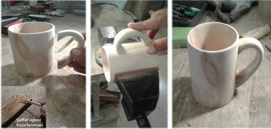
Görsel-17: Kulpun yapıştırılması ve tamamlanmış söğüt bardak.
