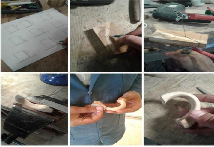
Görsel-16: Kulpun kıl testere ile kesilmesinin ardından eğe ve zımpara ile rötuş yapılması.
