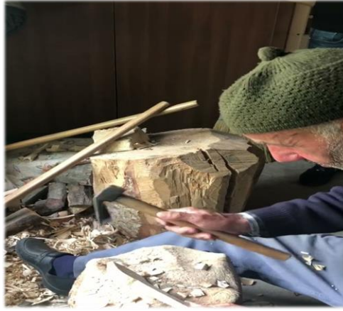
Fotoğraf 12: Kaşık keseri ile kaşığın tabla kısmının derinlemesine oyulması
