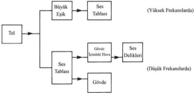
Şekil 3. Ud Çalgısında Ses Oluşum Sürecinin Şematik Gösterimi (Değirmenli, 2014).
