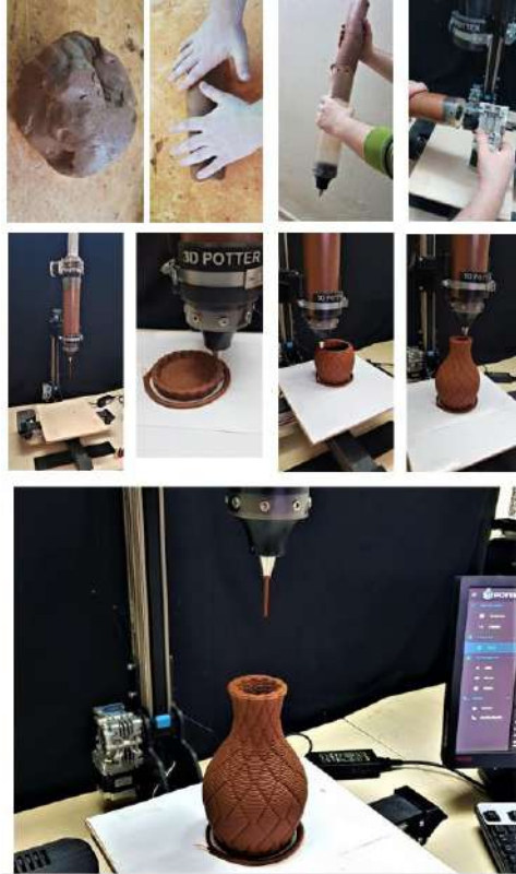
Şekil 11. Geleneksel yöntemlerle hazırlanan ve ekstrüzyon uygunluğu tespit edilen kilin 3B yazıcıda çıkarılış aşamaları ve form görüntüsü. (Fotoğraf: S.Ünal)
