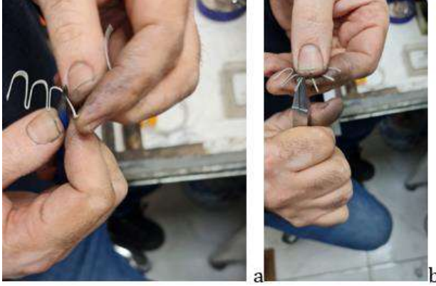
Fotoğraf 14a.b. Telin Şekillendirilmesi, Tarak.
