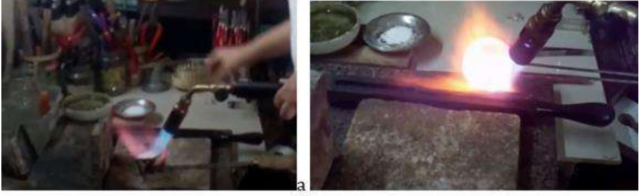
Fotoğraf 1. Gümüşün Eritilmesi
