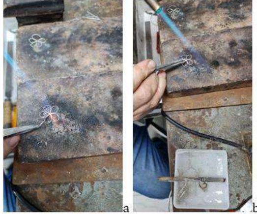
Fotoğraf 16a.b. Kaynak İşlemi, Teneker.
