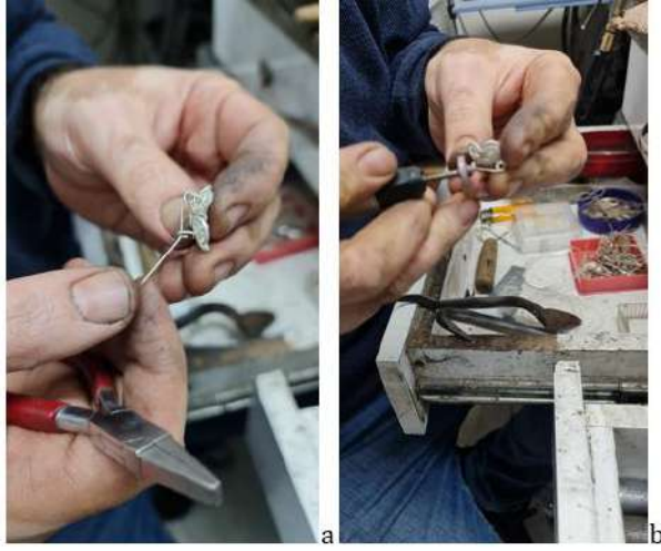
Fotoğraf 25a.b. İğne Eklenmesi.
