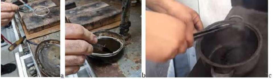
Fotoğraf 7a.b. Tavlama ve Soğutma İşlemi
