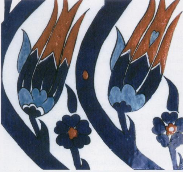
Gürbüz TAŞKIRAN, Ürkütme Deneyi 200 °C: Sır çatlağı Yok Pişme Derecesi; Bisküvi: 850 °C Sır pişirimi: 930 °C Toplam Küçülme: %6.5 Su Emme: %9
