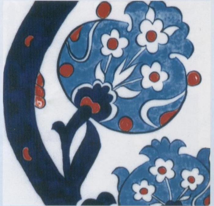
Gürbüz TAŞKIRAN, Ürkütme Deneyi 200 °C: Sır çatlağı Yok, Pişme Derecesi; Bisküvi: 850 °C Sır pişirimi: 930 °C Toplam Küçülme: %3 Su Emme: %12
