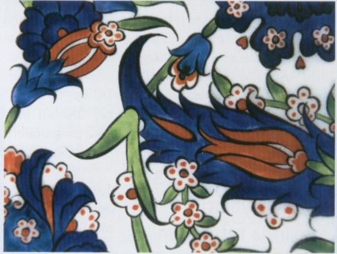
Aylin TOYLU, Ürkütme Deneyi 200 °C: Sır çatlağı Yok Pişme Derecesi; Bisküvi: 850 °C Sır Pişirimi: 950 °C Su Emme: %14
